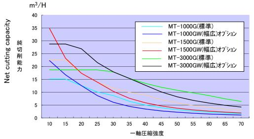
本表は純切削能力を示します。 実掘削能力は岩質等により著しく影 響されますので、本表の値は目安と して下さい。
