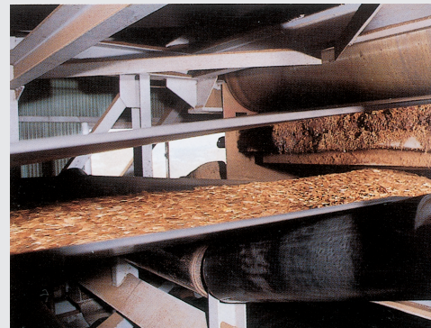
① 上部水平部 (吐出状況) Upper side horizontal section (discharge condition)
